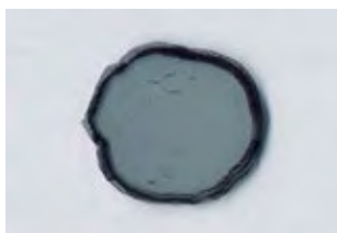
オープン 70°C×1時間加熱後 ヒートサイクル試験 25サイクル Oven-heated to 70°C for 1 h + 25 cycles
